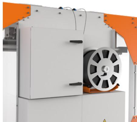
Die neu designte Spulenhaltung garantiert optimale Materialverarbeitung. Sie ist für alle gängigen Spulengrößen ausgelegt und fasst zwei Spulen mit einem Gewicht von bis zu 8 kg. Ein Sensor erkennt wenn kein Filament mehr vorhanden ist und pausiert den Druck, damit Sie die Spule austauschen können – unverzichtbar vor allem bei großen Drucken. Die optionale **Keep-Dry-Box** schützt Ihr Filament vor Staub und Feuchtigkeit.
